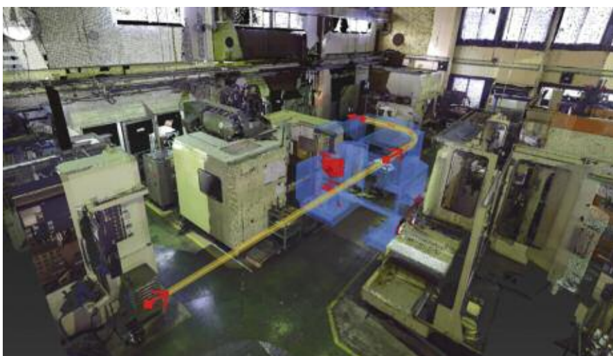
Bild 2: Kollisionserkennung zur Installationsplanung
